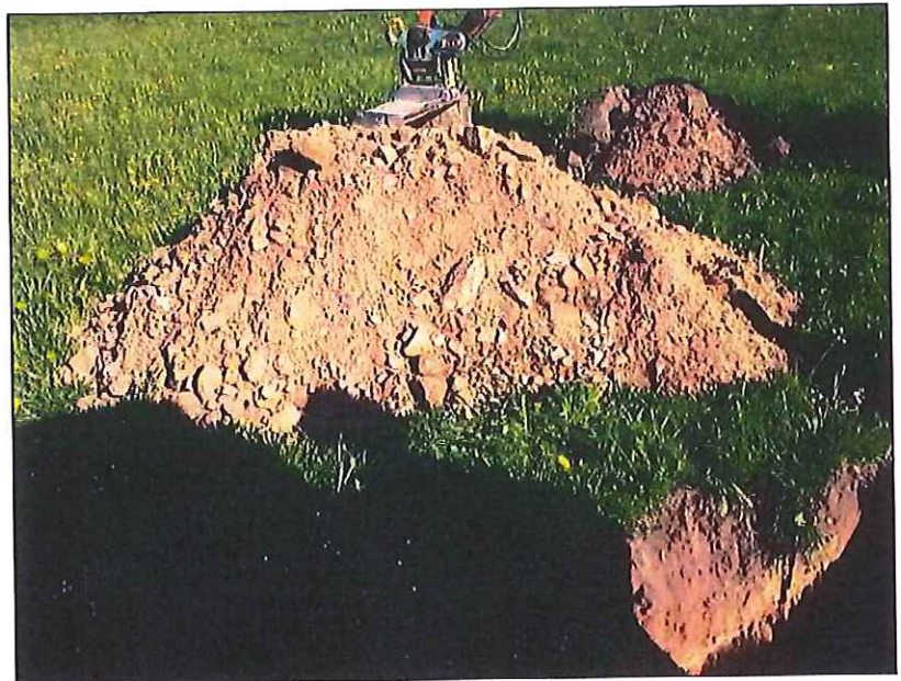
Abb. 3: Blick in Schurf S 2, grobe Norddrachschotter, im Sohlbereich aufsteigendes Grundwasser
