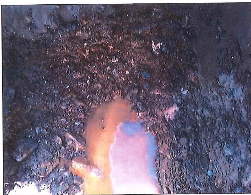
Abb. 9: Blick in Schurf S 5, grobe Norddrachsotter, im Sohlbereich aufsteigendes Grundwasser
