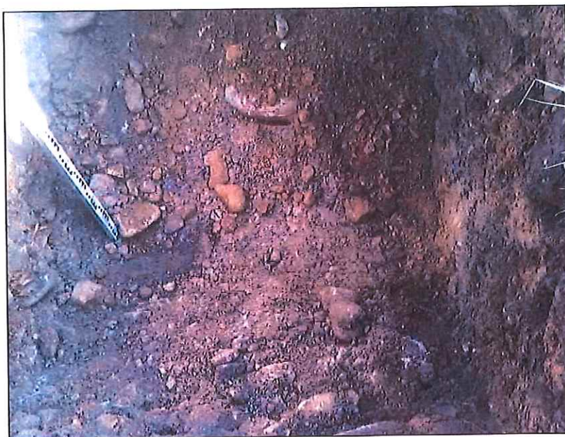
Abb. 3: Blick in Schurf S 2, grobe Norddrachschotter, im Sohlbereich aufsteigendes Grundwasser
